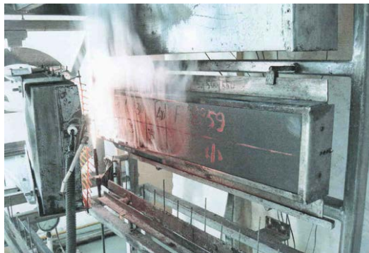
阿莱斯柔性绝热材料通过最严格的IMO防火测试，并由DNV出具鉴证报告。
